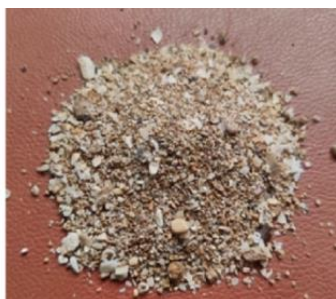
شکل ۱- ماسه کربناته استفاده شده در این پژوهش
