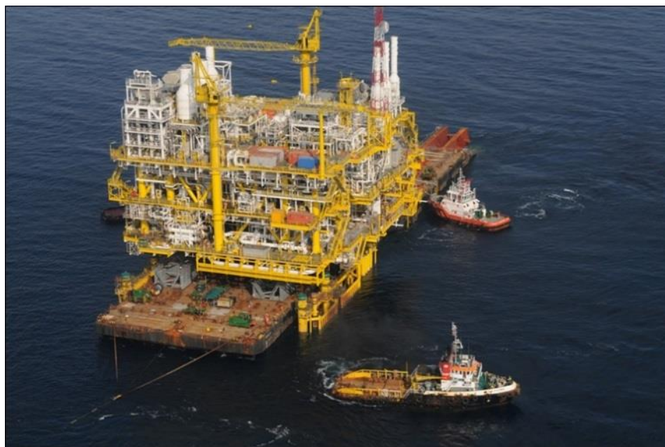
شکل ۲ - حمل سکو به روش شناوری برای حذف یا نصب [۱۳]
